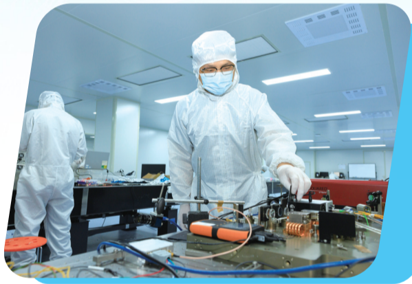
华创鸿度技术人员正在对激光器进行电路回测。赵明/摄
