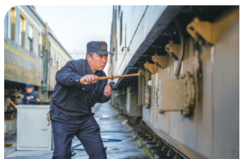
对旅客列车进行出库前的状态检查
