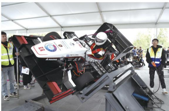
对赛车进行倾斜测试,确保车辆设计符合要求
