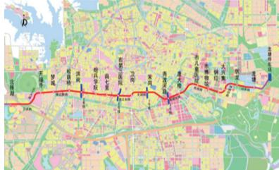
轨道交通4号线南延线位于肥西县境内,线路起于金桥路站,沿玉兰大道、大潜山路、繁华大道、永和路、习友路敷设,衔接4号线北雁湖站。线路全长13.9km,共设8座车站(3座地下站,5座高架站)。新建华南城车辆段,车辆段位于肥西县汤口路、华南大道、孙集路(规划)和玉兰大道围合地块内。
