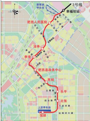
轨道交通3号线南延线位于肥西县境内,线路起于馆驿路站,沿杭埠河大道、青龙路、站前路、金寨南路、翡翠路敷设,衔接3号线幸福坝站。线路全长11.3km,共设8座车站,均为地下站。新建深圳路停车场,停车场位于杭埠河大道、三合路、袁店路、创新大道围合地块内。
