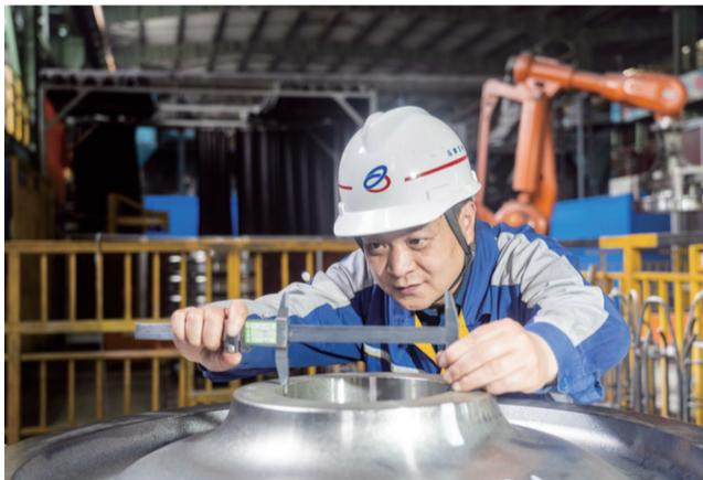
沈飞在测量车轮尺寸
