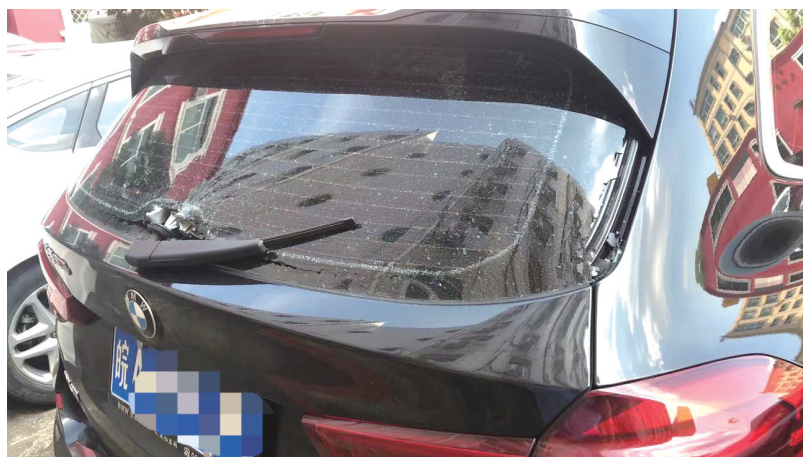
因后备箱盖自动打开导致受损的后挡风玻璃
