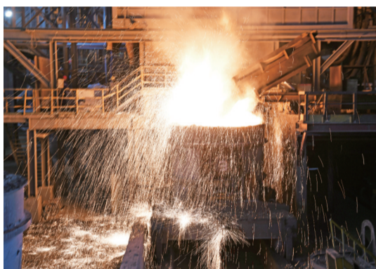
淮南市宏泰钢铁有限责任公司工人对刚出炉的钢水进行二次精炼 陈彬/摄
