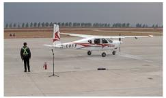
10月28日上午,随着一阵轰鸣声,我国自主研制的 首架四座电动飞机RX4E飞机冲破风雨,在辽宁沈阳财 湖机场首飞成功。四座电动飞机RX4E飞机是由辽宁 通用航空研究院全新研制的新能源通用航空产品,飞机 翼展13.5米,机长8.4米,起飞重量达1200公斤,续航时 间1.5小时, 航程300千米。后续随着电池储能技术的 发展, 航时航程可进一步提升。 □ 新华社发
