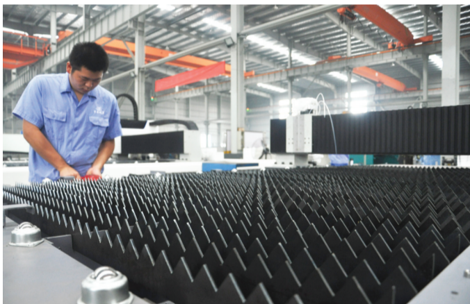
工人在装配激光切割机零配件
