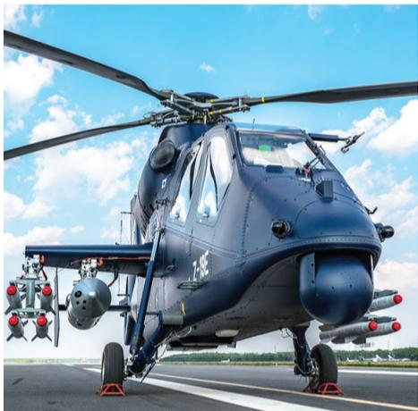
不可收放式起落架形式，配备了小型化、综合化的航电武器系统，具有多机空地信息化协同，连续、快速攻击多目标的能力，可在全天候、复杂战场环境和野战保障条件下遂行对地攻击、对地火力支援和对空作战等多种任务。该机空机重量较小，最大起飞重量4250千克，有效任务载荷大，在巡航速度、爬升率、使用升限和航程等方面具有明显优势。与国外同级别武装直升机相比，该型机具有体积小、灵活度高等特点，良好的机动性和卓越的作战性能使其在国际军贸领域具有广阔的市场前景。
