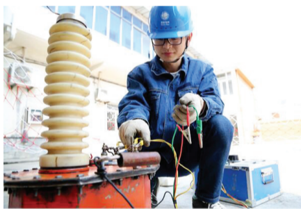
近日,长丰供电公司员工在杨庙供电所对该所的安全工器具进行试验,包括绝缘手套、绝缘靴、绝缘杆等工器具的绝缘、耐压试验。 ■张坤 杨胜伟 文/图
