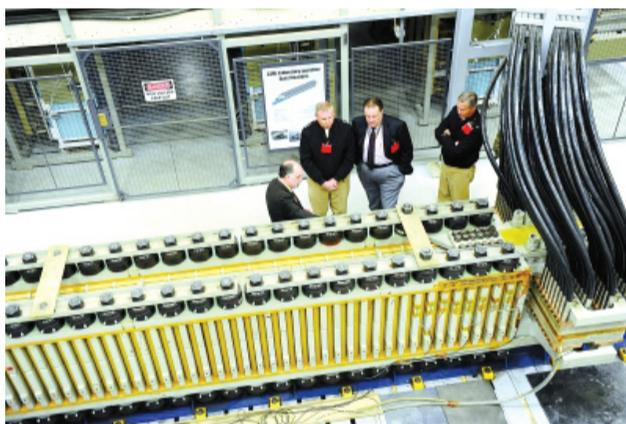
美军进行电磁轨道炮试验
