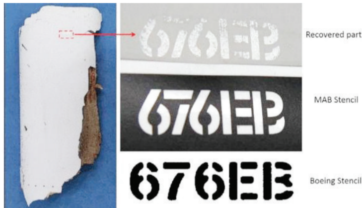
经过比对,第一块残片上的数字“676EB”、字体和字母颜色均属于马航购买的波音飞机独有的制作工艺。
