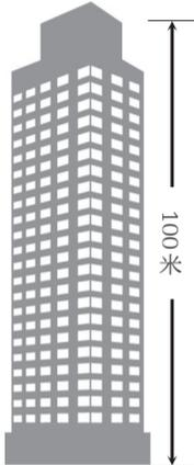
水库大坝、一百米以上的高层建(构)筑物、一公里以上的隧道、特大的桥梁、广播电视发射塔及其他重大建设工程,应当按照国家有关规定设置强震动监测设施。
