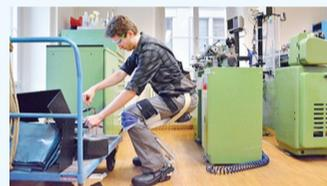
近日瑞士研究员发明了一张外骨骼“隐形椅”,可以让使用者随时随地坐下休息。报道称,这套机械利用皮带把一套支架紧扣在腰间和大腿,由连接特制鞋子的避震器支撑体重。另一个版本的“隐形椅”则可配合任何鞋子使用,用户只需预先固定外骨骼的姿态,启动电源,外骨骼便会接触地面支撑身体。
