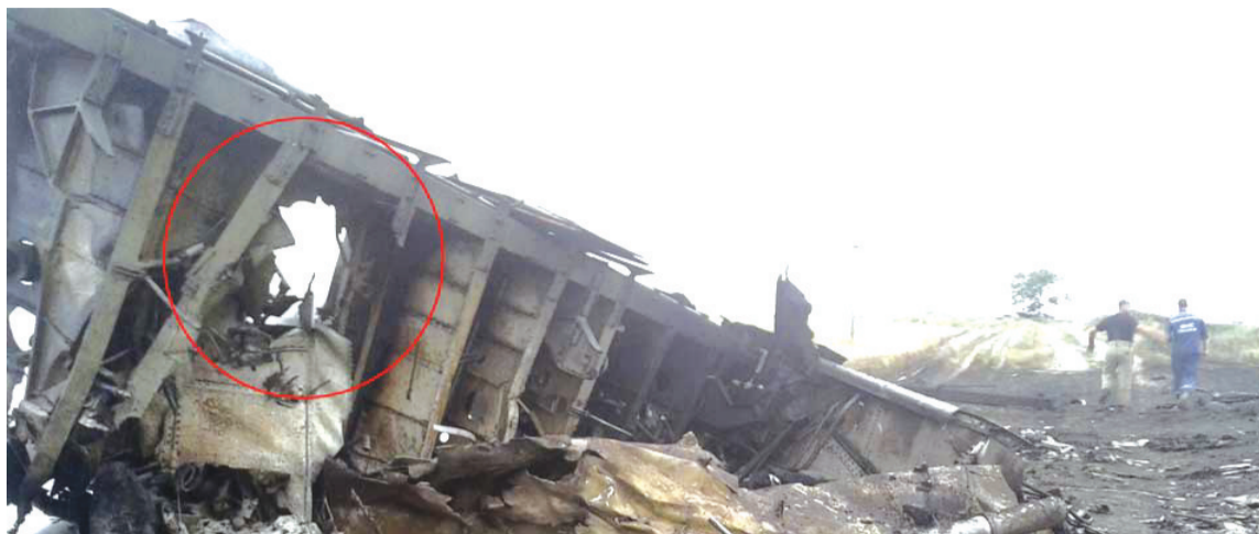
从这张残骸照片来看，机身上有比脸盆略大的孔洞，破坏方向从机体外部冲向内部，怀疑是导弹的破片击中的区域。
