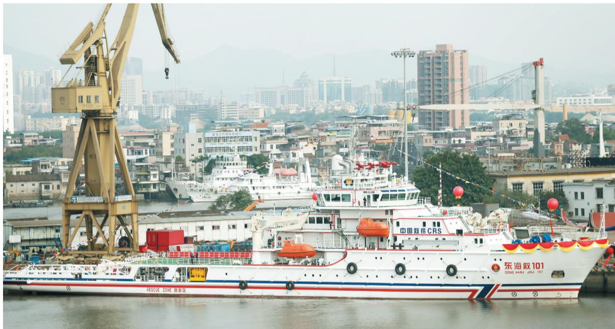
10月31日,中国目前马力最大、救助设备最为齐全的远洋专业救助船“东海救101”轮在广州中船黄浦造船有限公司交付给交通运输部使用。“东海救101”轮总长116.95米,型宽16.2米,满载排水量6513.13吨,最大马力达到14000千瓦。据了解,“东海救101”轮编后将成为我国东部海区的救助旗舰,承担起东部海区海上救助工作。
