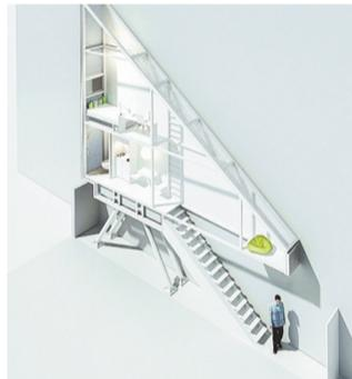
波兰首都华沙10月20日建成世界上“最窄的”房屋,这套房子当天迎接它的第一位居民入住。房子建在两栋大楼之间,空间极度狭小。最宽的地方为1.2米,最窄处仅有0.7米。这套房是三角形,有9米高,底部最长处有10米。虽然分上下两层,但是加起来还不到5平方米。房子底部由金属管支撑起来,距离地面3米。房子一楼有卫生间,马桶座上面就是淋浴喷头,可以洗澡。迷你厨房里还有冰箱,可以存放几瓶饮料。一楼有一张双人餐桌和一个小沙发。在二楼的卧室里有床、书桌和椅子。房屋的电源来自旁边的大楼。 李季
