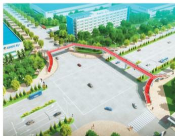
昨日,记者获悉,位于市区明珠大道上格力北门的人行天桥有望于十月一日前后正式投用,目前已完成主体结构施工。格力北门人行天桥为“L”字型,主桥宽5米,长度为100米,桥与路面净空高度为5.5米。同时,天桥布置三处上下行梯道,上部采用钢箱梁结构。正式投入使用后,这座人行天桥将能消除企业大量员工横穿马路的安全隐患,惠及格力、世纪精信等周边企业,3万员工出行安全问题得以进一步保障。 姚书凯 星级记者 徐涛
