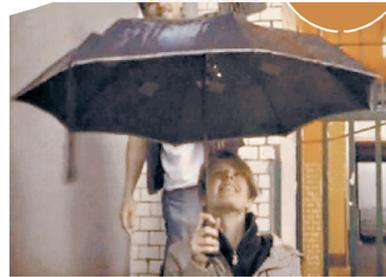
德国两名计算机黑客察佩和拉格尔夫发明了一款音乐雨伞,借助压电材料制成的传感器,让洒落伞盖的雨点演奏音乐。发明者用布基胶带,在伞盖内侧粘上12个快速反应传感器,连接简单的电路板。传感器由压电材料制成,当感受到压力或遭扭曲时会产生微弱电量。因此,当雨点落在伞盖上,传感器受压,产生电能,汇入一个Arduino单片机。这种单片机是一块覆着硅片的电路板,上有多个连接器,可以读取传感器信号,分析数据,然后输出回应,借助发声器发出哔哔声。每个传感器对应不同的哔哔声,合成8比特旋律。整个过程最难的部分是调节单片机,以便让它发出悦耳动听的哔哔声。察佩和拉格尔夫眼下正致力于改善音乐雨伞的外观,把线和传感器缝在伞盖上,以便奏出更悦耳的旋律。
