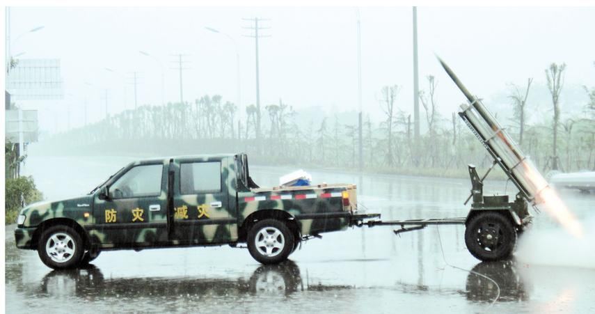
6月30日,气象工作者在亳州市南部新区实施火箭弹人工增雨作业。当日,亳州市气象部门抓住有利时机,利用天气因素,在全市多处增雨点及时组织开展人工增雨作业。据亳州气象台负责人介绍,截止到6月30日全市累积雨量30~60毫米,部分地区80毫米以上,旱情基本解除,确保夏种夏播作物出苗和苗期生长。 刘勤利 马魁侠/摄
