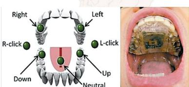
据美国《大众科学》杂志2月27日报道，美国佐治亚理工学院的研究人员发明出了一种可以装在舌头上的微型磁性装置，它可以使残疾人通过舌头操控轮椅。这套舌头驱动系统包括一组安装在舌头和上下牙齿里的微型磁铁感应器和一组安装在口腔上方的防水“牙套”传感器。舌头通过触碰不同位置的磁铁感应器发出信号，“牙套”传感器再把经过转换的无线信号传给手机或平板电脑等移动设备，然后移动设备再把指令传达给使用者希望操控的对象。
