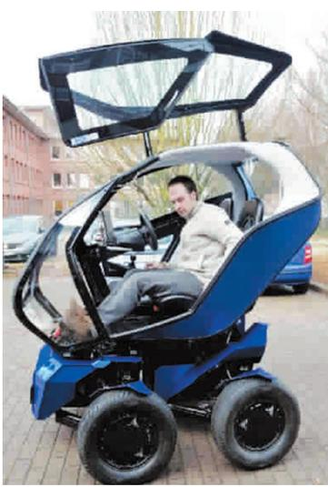
德国人工智能研究中心近日推出一款人工智能“变形”电动车，该车行动灵活，可根据现有交通状况“变形”，将来还有望实现自动驾驶。人工智能研究中心将这种变形车称为“EO智能连接车”，该车底盘灵活多变，可通过减小底盘、升高驾驶室实现“变形”，变形后可将多辆同款车型连接起来，形成“公路列车”，不仅节省空间，且易于操控。
