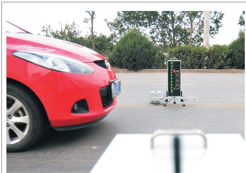
近日,在省城科学岛附近的路面上,工作人员正在测试新型机动车尾气遥测系统。据了解,该套设备通过红外及高速摄像等技术手段,行驶中的汽车无需停下就能测出尾气排放是否超标。
