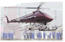
中国目前最大的 V750 无人直升机 5 月7日在山东潍坊首飞成功,填补了中国 中型无人直升机的空白。据了解, V750 是目前中国最大的无人直升机,由B2B 双座有人驾驶飞机改装而成,起飞重量 为757公斤,任务载荷大于80公斤,最 大平飞速度为每小时161公里,最大航程 为500公里,续航时间大于4小时。该机 可人工遥控,也可以程控自主飞行,两种 模式在飞行过程中可以切换。V750无人 直升机的控制半径超过150公里,使用升 限为3000米。专家表示,目前这一机型 首飞成功,之后将转入科研试飞阶段,完 成按航线的程序飞行之后才可以算是试 飞成功。
