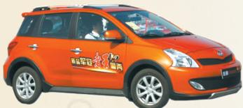
手自一体炫丽 AMT 车型,为一款低碳环保的精品小车,拥有高动力、低油耗、易操控的特点。炫丽 AMT 虽为1.3L排量,但动力超越了很多1.4L车型,其综合工况油耗仅为6.5L/百公里。在6月底公布的“节能产品惠民工程”节能汽车推广目录中,炫丽1.3
