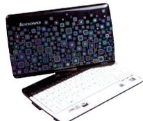
联想IdeaPad S10-2采用10.1英寸宽屏幕(LED背光模组)设计,配备了Intel Atom N270处理器(1.6GHz主频/512KB二级缓存/533MHz前端总线)、Intel 945GSE+ICH7M芯片组、1GB DDR2内存、160GB硬盘和Intel GMA950集成显卡。
